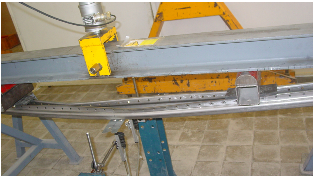
Fig. A.2: Fallida de l'assaig a flexió a 4 punts de força en posició d. Fallida per vinclament distorsional.
