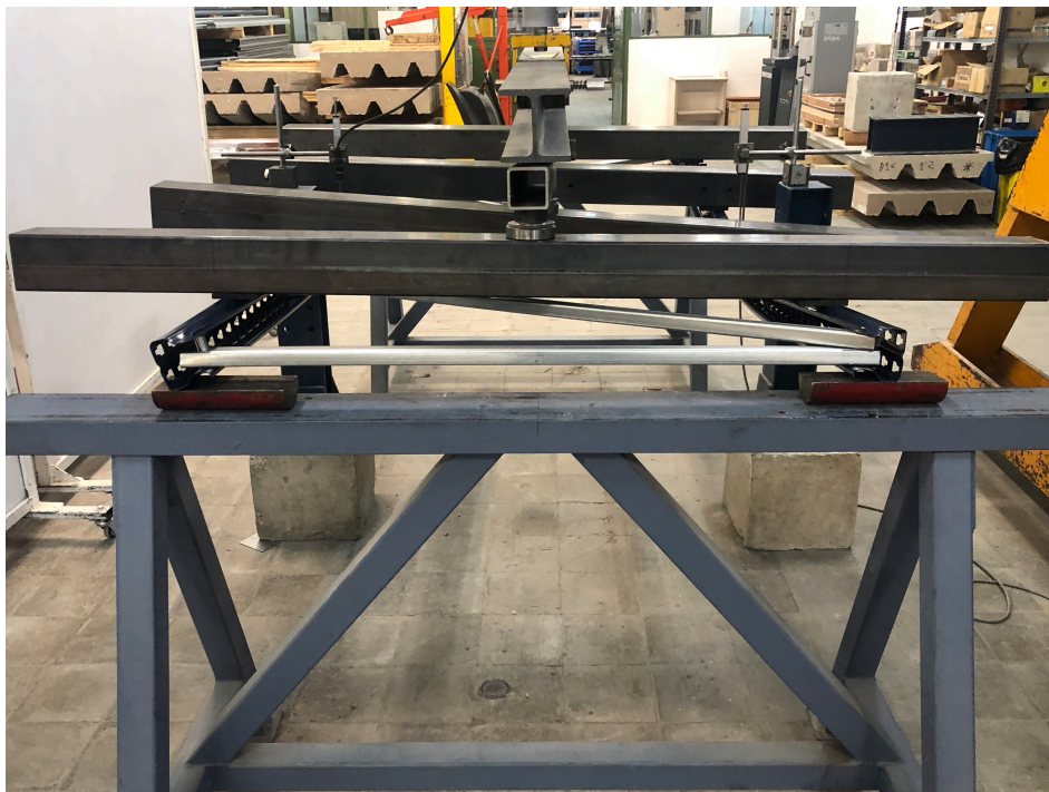
Fig A.4: Fallida de l'assaig a flexió a 6 punts de força en posició b. Fallida per abonyegament al punt de càrrega.
