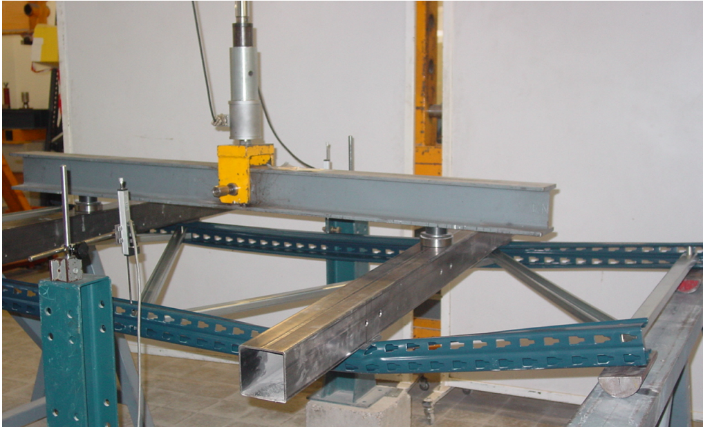
Fig. A.1: Fallida de l'assaig a flexió a 4 punts de força en posició b. Fallida per abonyegament en el punt de càrrega.
