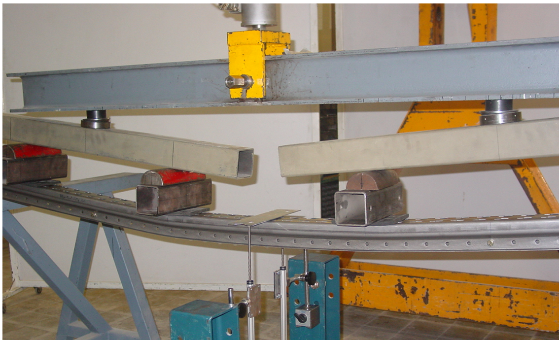
Fig A.6: Fallida de l'assaig a flexió a 6 punts de força en posició e. Fallida per abonyegament en el punt de càrrega.
