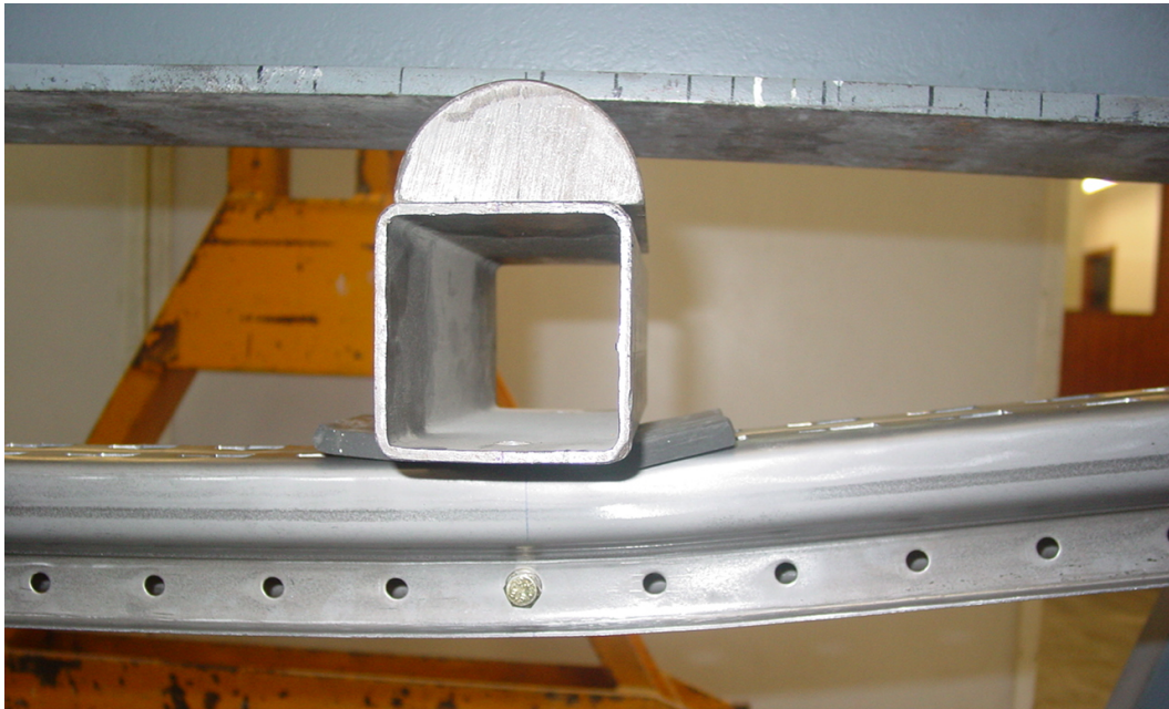
Fig. A.3: Fallida de l'assaig a flexió a 4 punts de força en posició e. Fallida per abonyegament en el punt de càrrega.
