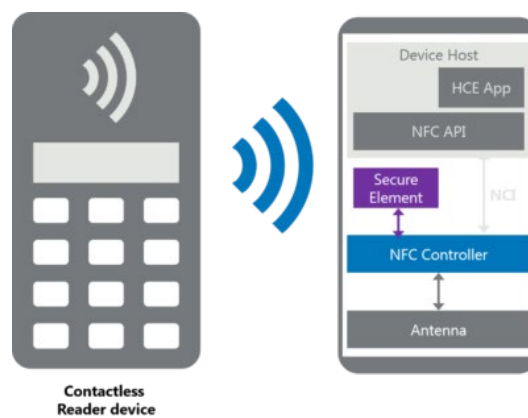
Figura 21: Modo emulación tarjeta basada en elementos seguros [32]
