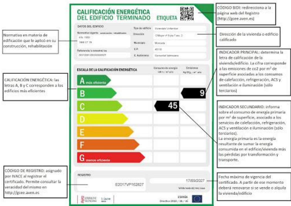
Fig 4.12. Exemple Certificació Energètica [15].
