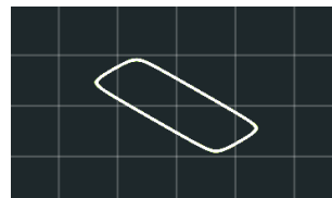
Figura 3.1.13 Señal Triangular y su señal desfasada en vectorial
