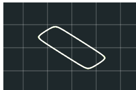
Figura 3.0.3 Señales X e Y mostradas en el display del osciloscopio en formato vectorial
