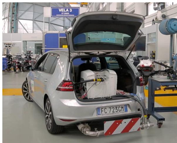
Figura 4. Imagen del sistema de medición PEMS completo. Fuente: JOVE
