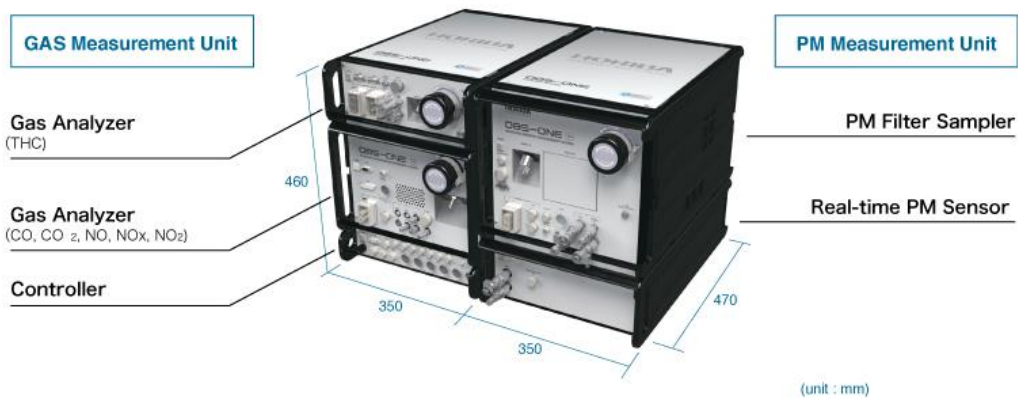
Figura 3. Módulos que componen un equipo PEMS. Fuente: HORIBA.
