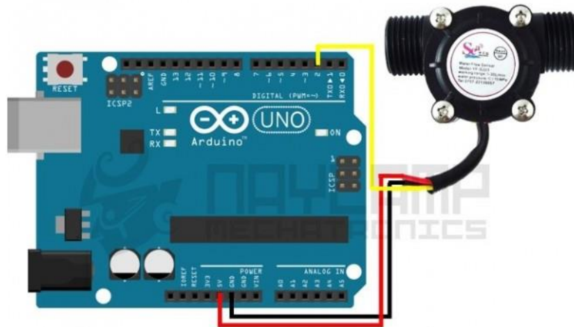
Figura 36. Esquema de conexiones del YF-S401. Fuente: Naylamp mechatronics.
