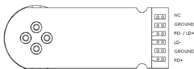
Ilustración 38: Imagen y esquemático PINOUT del TOSA
