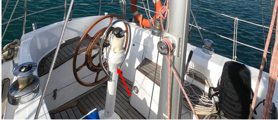
Figura 73. Ubicación bombona de gas
