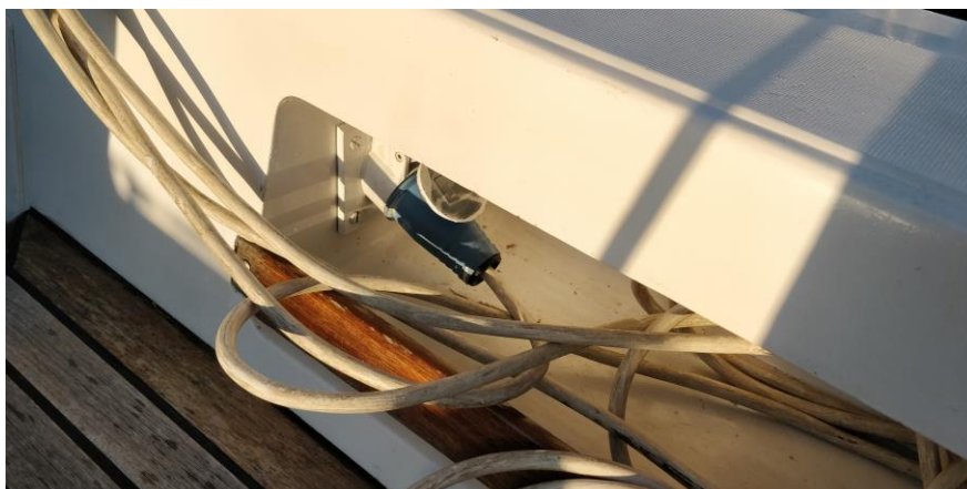
Figura 31. Enchufe de toma a puerto del barco
