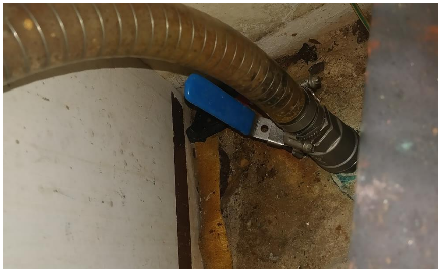
Figura 92. Grifo de fondo situado al costado del lavabo de proa
