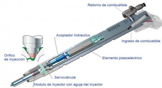
Figura 4. Funcionamiento del efecto piezoeléctrico en un inyector de combustible. Obtenido de [16]
