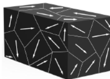
Figura 18. Estructura de un material policristalino. Obtenido de [24]
