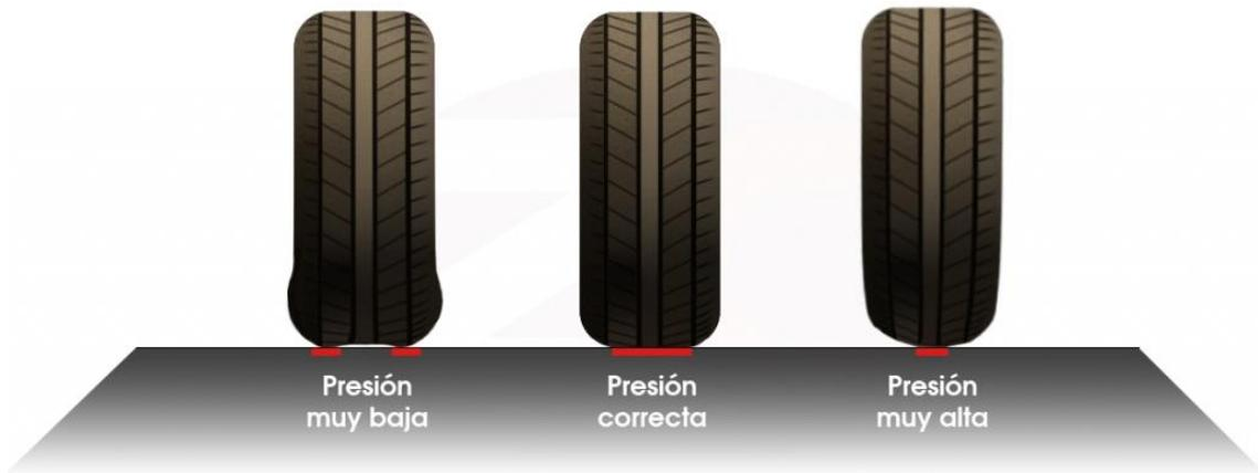
Figura 62. Superficie de contacto de un neumático en función de la presión que contiene. Obtenido de [46]
