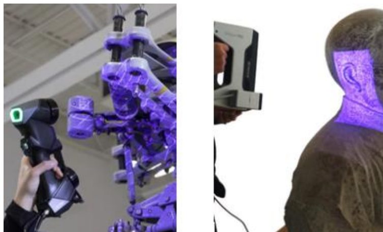
Ilustración 9: Patrón laser y patrón de luz estructurada
