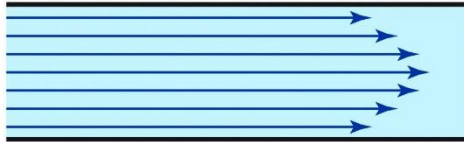
Ilustración 17: Líneas de corriente en un flujo laminar
