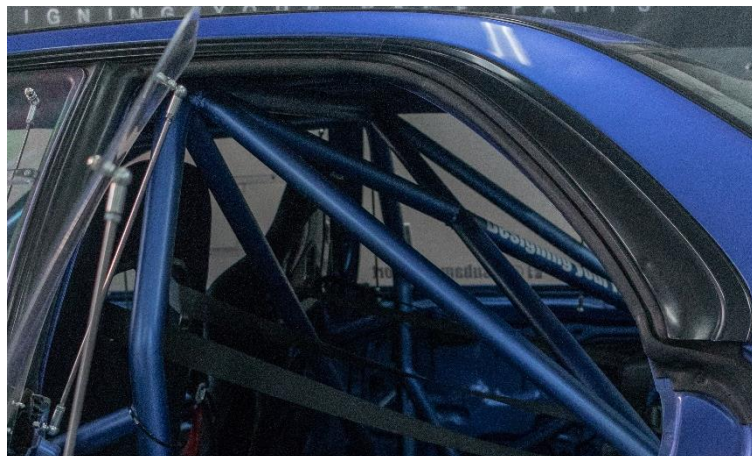
Ilustración 3: Detalle jaula de seguridad
