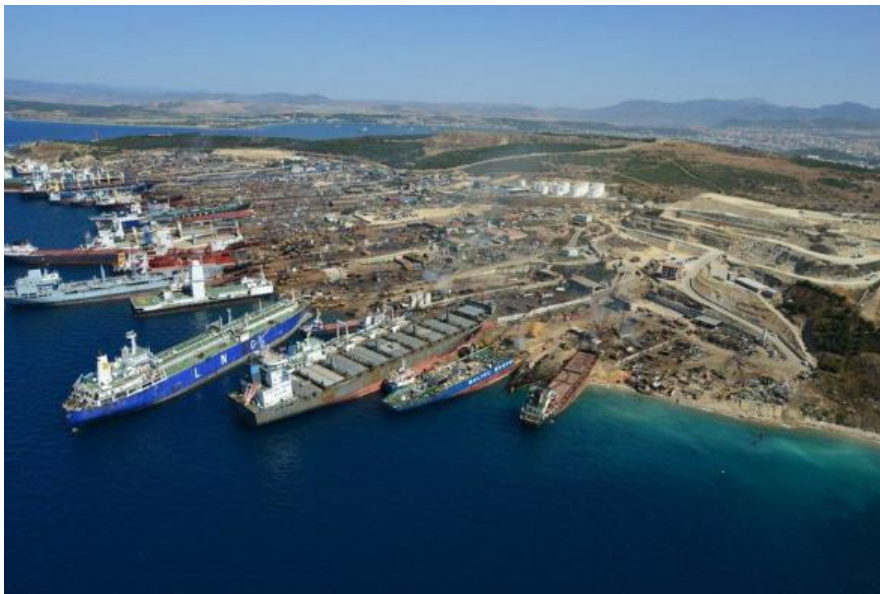
Imagen 7. Buques desguazándose mediante el método Landing. Fuente: NGO ShipBreaking Platform
