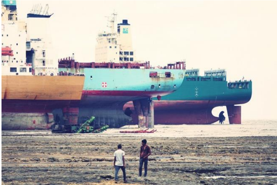
Imagen 5. Buques desguazándose mediante el método Beaching. Fuente: bellona.org
