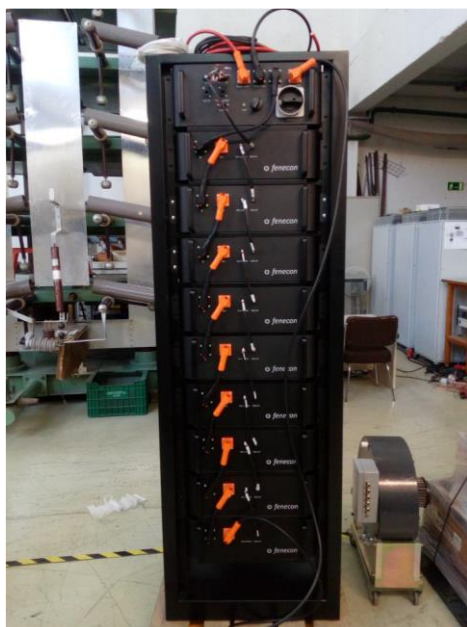
Fig. 11. Bateria recarregable assajada amb inversor
