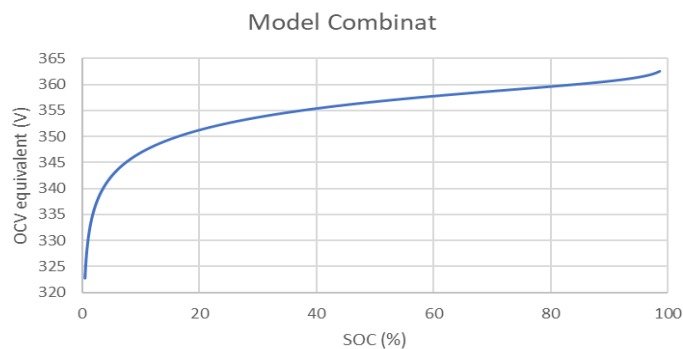
Fig. 41. OCV en funció del SOC pel model Combinat
