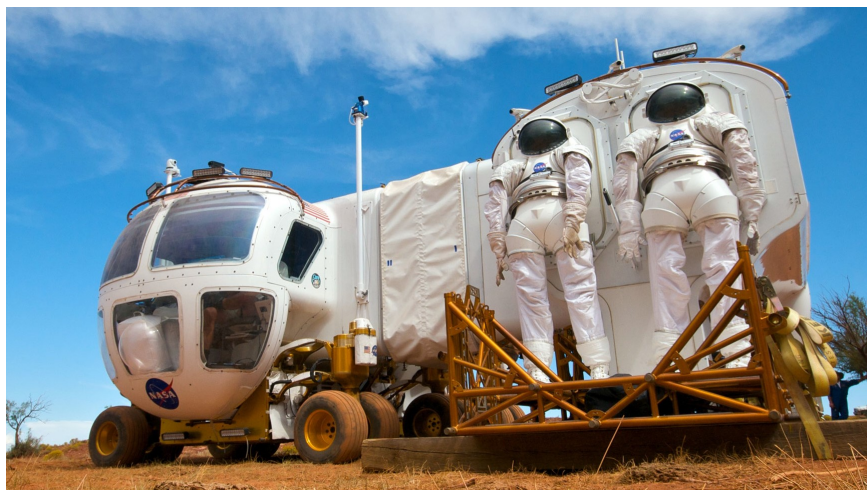
FIGURA 2.45: Suitport acoblat al SEV de la NASA [1]
