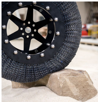
FIGURA 2.18: Disseny de les rodes sense aire de la NASA [17]
