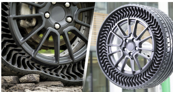
FIGURA 2.16: Disseny de la roda sense aire Michelin Uptis [15]
