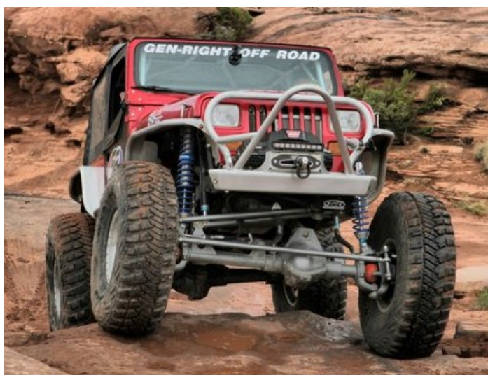
FIGURA 2.20: Il·lustració del sistema de suspensions rígid [19]
