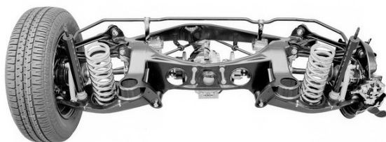
FIGURA 2.23: Representació del sistema de suspensions d'eix oscil·lant [19]
