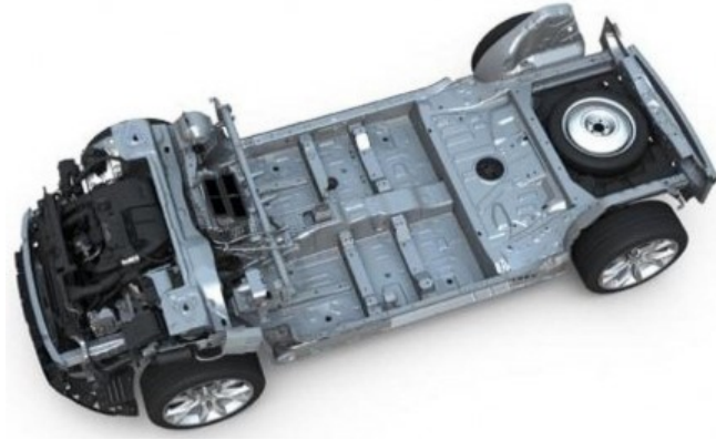
FIGURA 2.31: Representació d'un xassís de plataforma [24]
