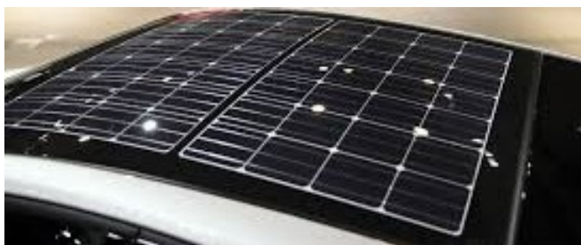
FIGURA 2.14: Representació de les plaques solars en el sostre del vehicle [13]
