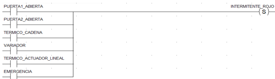
Figura 87. Ladder sección alarmas pulmón [2].
