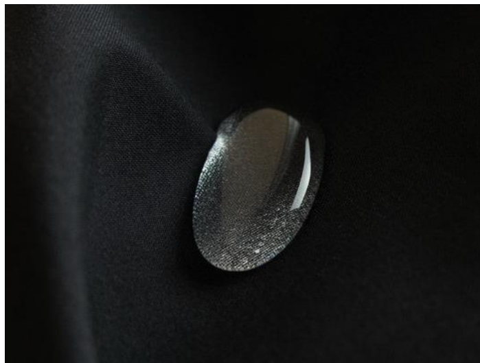
Figura 23. Forma de gota d'aigua sobre teixit impermeable i transpirable intel·ligent de Diaplex.
