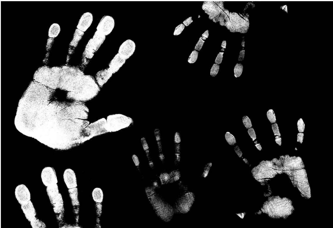
Ilustración 7: Reacción de superficie termocrómica a temperatura 36°C Ilustración: propia
