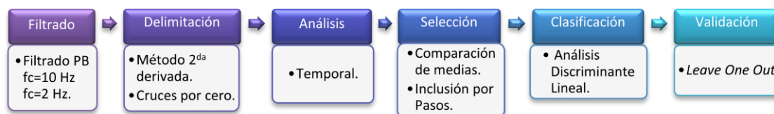
Fig 2 Esquema donde se pueden ver las distintas etapas de procesamiento
