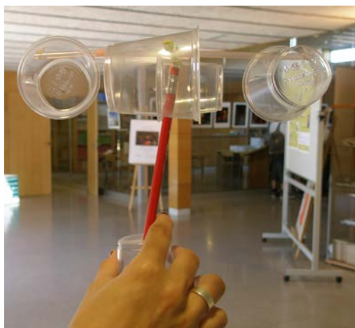
Figura 2. Detall d'un anemòmetre construït en el taller Construcció d'equips meteorològics simples dins del curs EXPLORA la meteorologia
