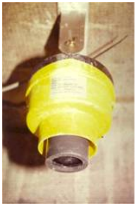
142 Fig. 1. Limnimeter inside a sewer
