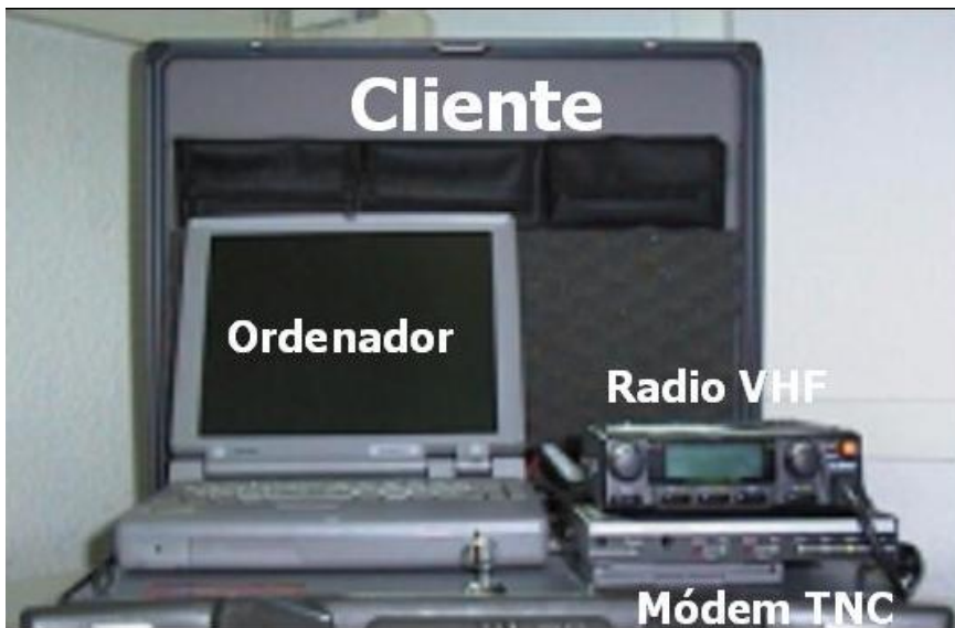
Equipos para sistema de comunicación de datos en VHF. Fuente: elaboración propia
