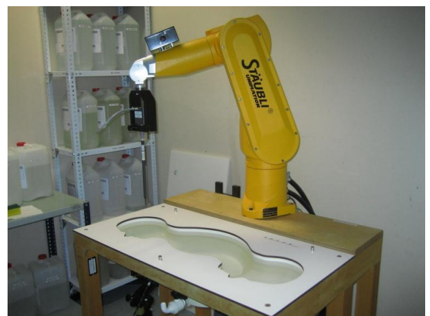
Fig. 4. DASY4, situado en los laboratorios de Fractus. Está formado por el brazo robótico, la sonda y el molde de las dos caras del phantom head .
