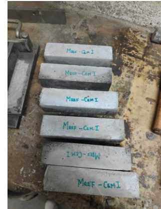
Fotografía 12. Desmoldado de probetas de referencia.
