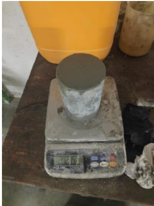
Fotografía 10. Ensayo de densidad del mortero.
