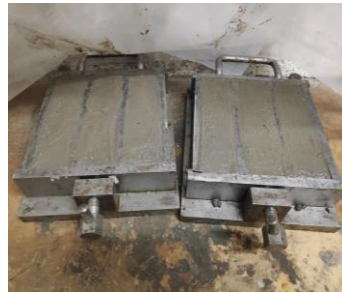
Fotografía 11. Enmoldado de las mezclas de referencia.
