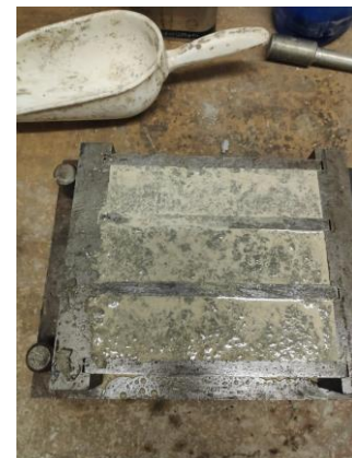
Fotografía 15. Muestras con 4% de fibras naturales.
