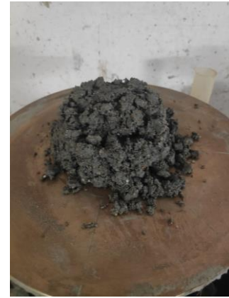
Fotografía 21. Consistencia de morteros con 6% de fibra natural.
