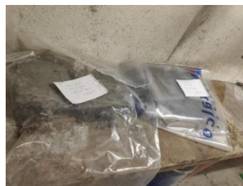
Fotografía 17. Probetas cubiertas durante 24h antes del desmoldado.
