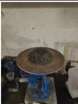
Fotografía 13. Ensayo de escurrimiento de mortero y fibras naturales.
