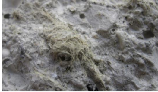
Figura 4. Grupo de fibras largas de cáñamo en un compuesto cementíceo.
