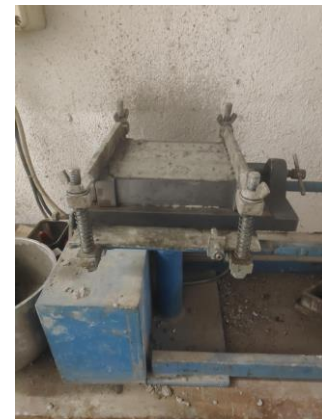
Fotografía 18. Llenado de probetas en la mesa de sacudidas.
