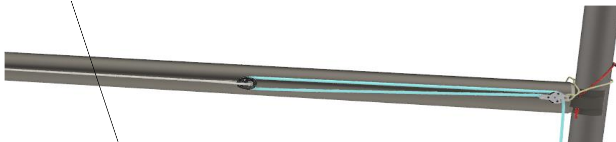
Il·lustració 191. Vista perspectiva del inici de la botavara. Sistema del pajarin. Modelat en Rhinoceros. Font: Pròpia
