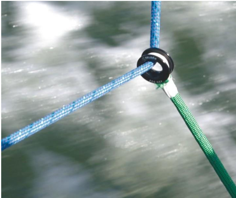
Il·lustració 168. Anell de baixa fricció amb cap embotit i cosit. Font: Seldén
