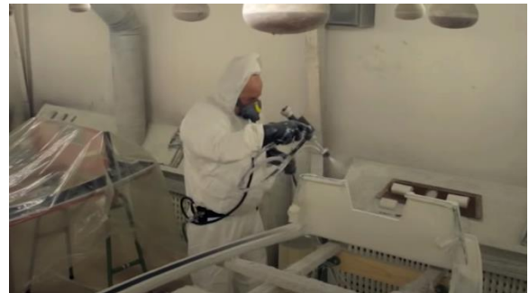
Il·lustració 33. Operari disparant gelcoat al motlle de la coberta. Font: Youtube (Winner)
