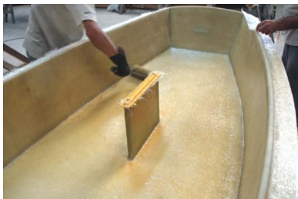
Il·lustració 34. Laminació manual d'un Optimist. Font: Astroboat
