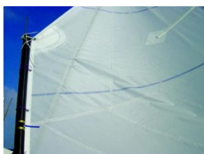
Il·lustració 89. Plecs de perxa poc tensa. Font: Quantum
