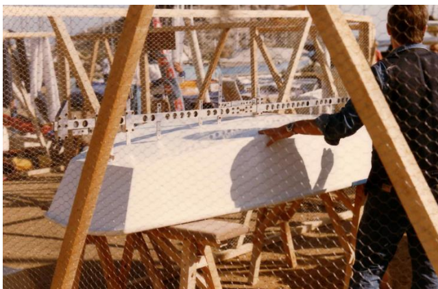
Il·lustració 14. Optimist passant mesuraments de curvatura. Font: [5]
