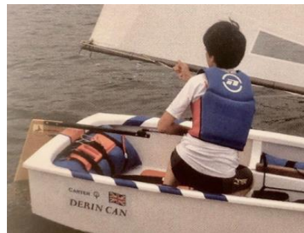
Il·lustració 83. Caçant el sistema de pajarin en cenyida. Font: [7]
