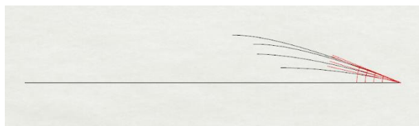
Il·lustració 54. Twist d'una vela d'Optimist. Projeccions de seccions de baluma en pla horitzontal. Font: Pròpia.
