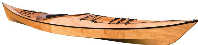
Figura 76. Kayak construït pel sistema "Stitch and Glue" - Imatge de Google
