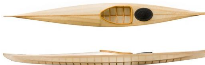
Figura 78. Kayak construït pel sistema "Canvas on Frame" - Imatge de Google
