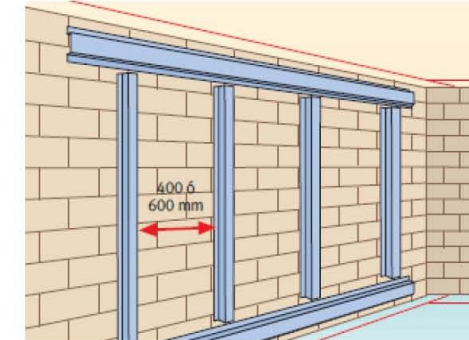
Muro ladrillo trasdosado a una cara
