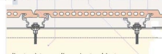
Sujeci3n mediante sistema clips – Junta abierta Piezas Huecas ceràmica de terracota hueca roja (300 x 1480 x 40 mm)
