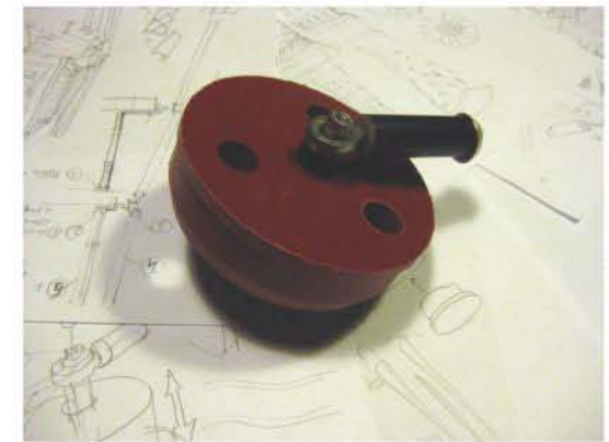
Encaix de poliestirè entre la ròtula i el tub cilíndric
