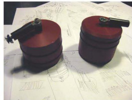
Encaix de poliestirè entre la ròtula i el tub cilíndric
