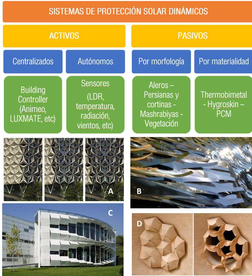
Podemos clasificar las fachadas responsivas de acuerdo a la energía que utilizan para su funcionamiento. De esta manera encontramos sistemas que necesitan de una fuente de energía para su funcionamiento y otros que a través de su forma y/o material se contraen y expanden respecto a la temperatura, al nivel de humedad ambiental u otros factores climáticos.
