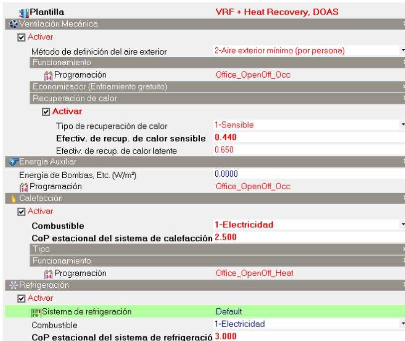
FIGURA 34: Captura de pantalla de configuración de HVAC y recuperador de calor
