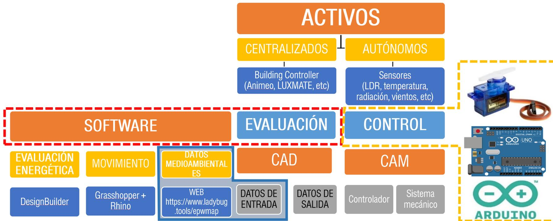
FIGURA 17: Diagrama de funcionamiento de sistemas activos
