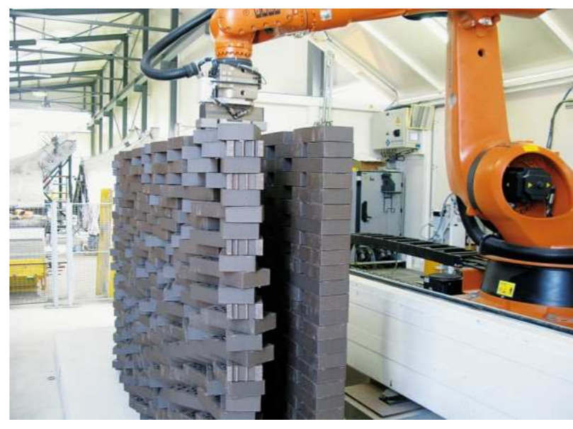
Brazo mecánico colocador de ladrillos
