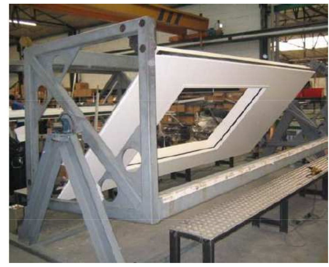
Paneles de hormigón prefabricados
