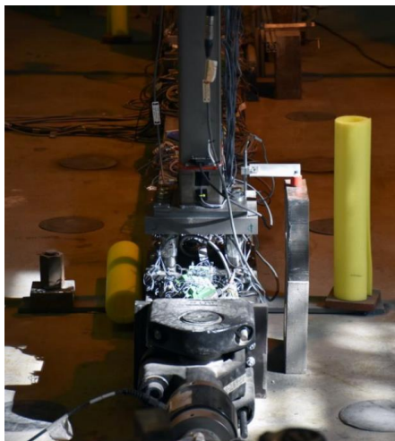
Figura 3.5.- Detalle del apoyo de columna, gato horizontal y célula de carga. (Arrayago et al., 2019c).
