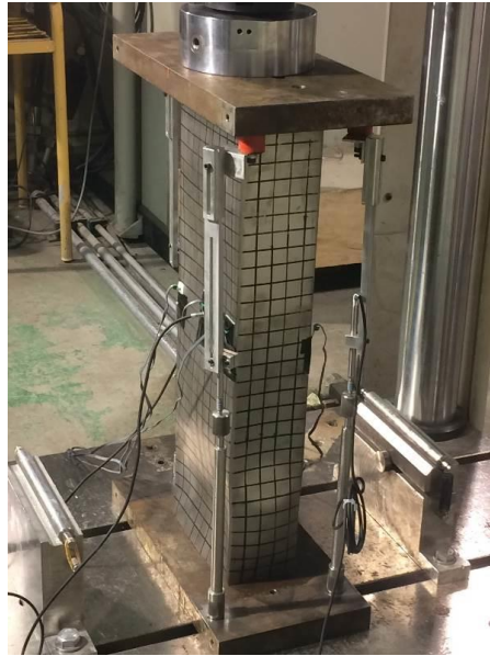
Figura 3.6.- Configuración de ensayo y modo de fallo de la probeta S4-SC. (Arrayago et al., 2019a).
