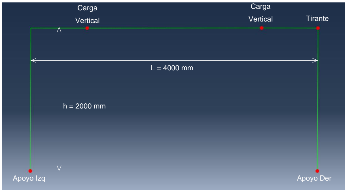
Figura 4.3.- Vista frontal del modelo S1_beam. (Abaqus)
