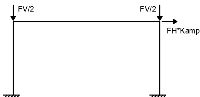
Figura 29 Esquema de cargas con amplificación para tener en cuenta efectos de segundo orden
