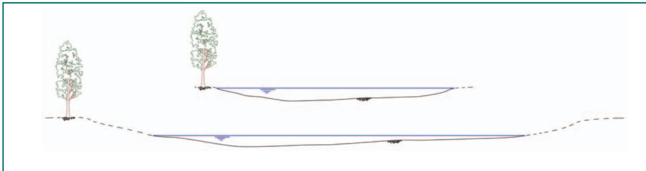
Fig. 9. Secciones transversales homotéticas. Arriba: de dimensiones más proporcionadas, la obtenida a partir de conceptos de régimen. Abajo: más parecida a lo que aforó De Mesa en 1863. Fuente: (16).
