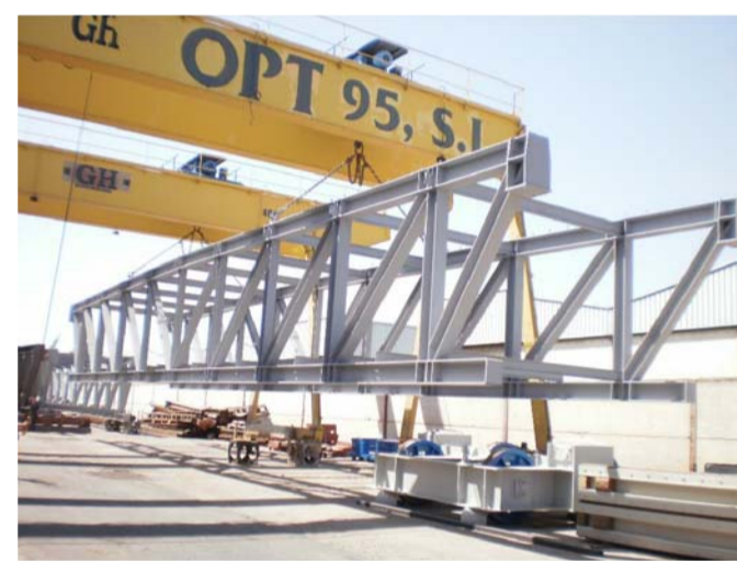
L'estructura és tota metàl·lica i amb unions soldades amb rigiditzadors on calgui.
