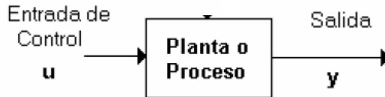
El bloque etiquetado como “**Planta o Proceso**” es el sistema que se desea controlar.
