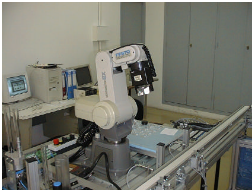
Figura 1- Vista de la estación de montaje y/o paletización con robot RV-M1 de Mitsubishi
