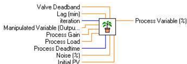
Figura 5.6 : Conexión de la PLANTA VI
