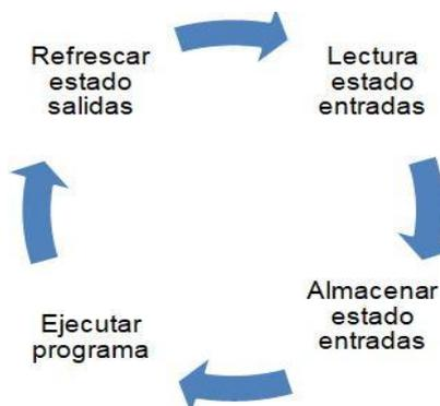
Ilustración 5: Ciclo SCAN de un PLC
