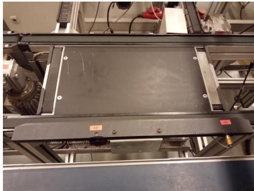
Ilustración 35: Plataforma neumática
