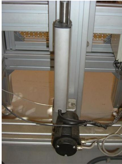
Ilustración 43: Motor actuador lineal
