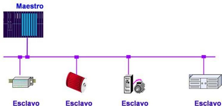
Ilustración 15: sistema maestro/esclavo en Profibus DP
