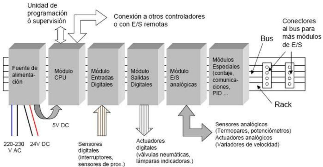
Ilustración 2: Arquitectura de un PLC
