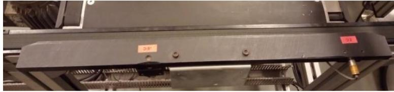
Ilustración 33: Detector inductivo basculante
