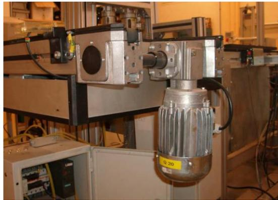
**Ilustración 36: Motores eléctricos cintas transportadoras**
