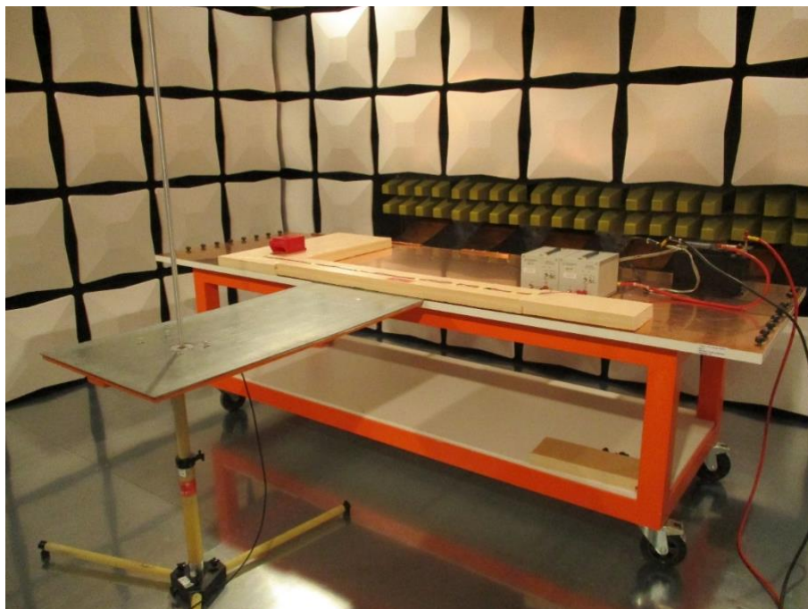
Figura 3.3 Antena monopolo utilizada en el ensayo de 150 kHz a 30 MHz.
