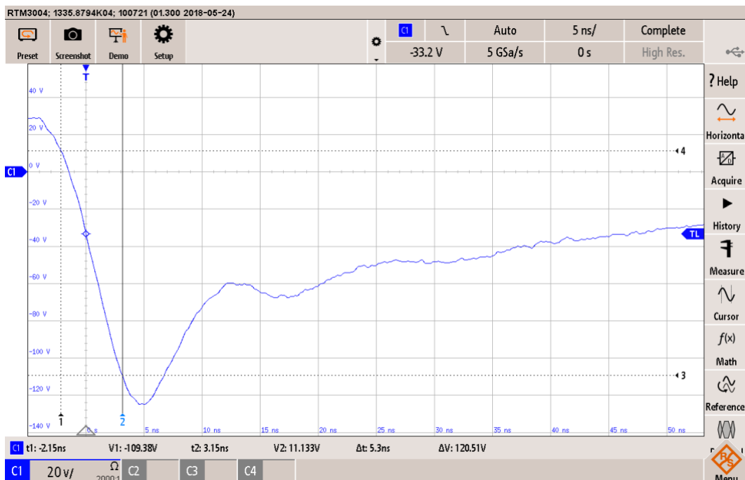
Figura M.30. Captura Pulso 2a. Parámetro: tiempo de bajada ( t_f ).
