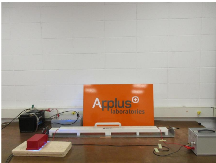
Figura 4.18 Disposición del EUT en el plano de masa según la normativa Ford FMC1278.
