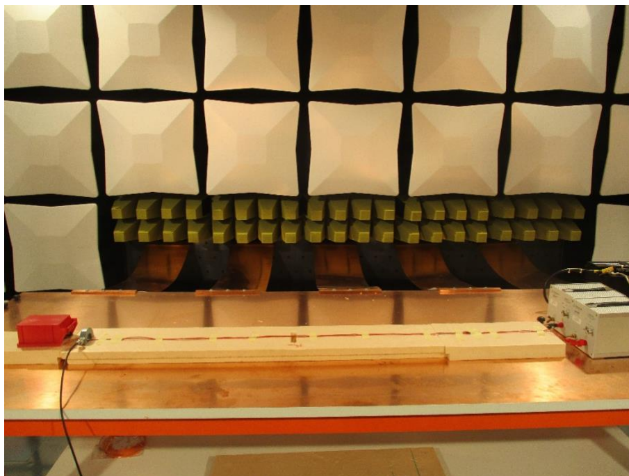
Figura 3.11 Disposición del EUT en el plano de masa según normativa FMC1278.
