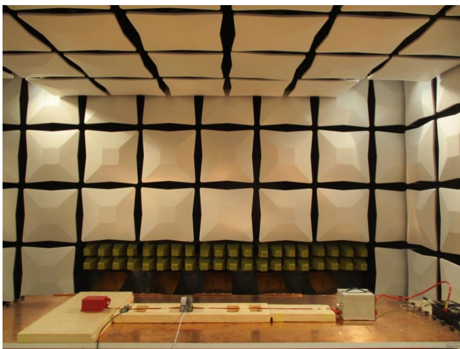
Figura 4.5 Disposición del EUT en el plano de masa según normativa FMC1278. Método CBCI.
