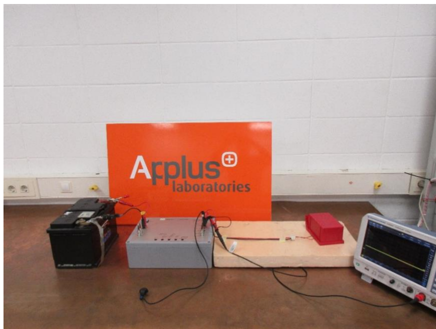
Figura 4.23 Disposición del EUT en el plano de masa según la normativa Ford FMC1278.
