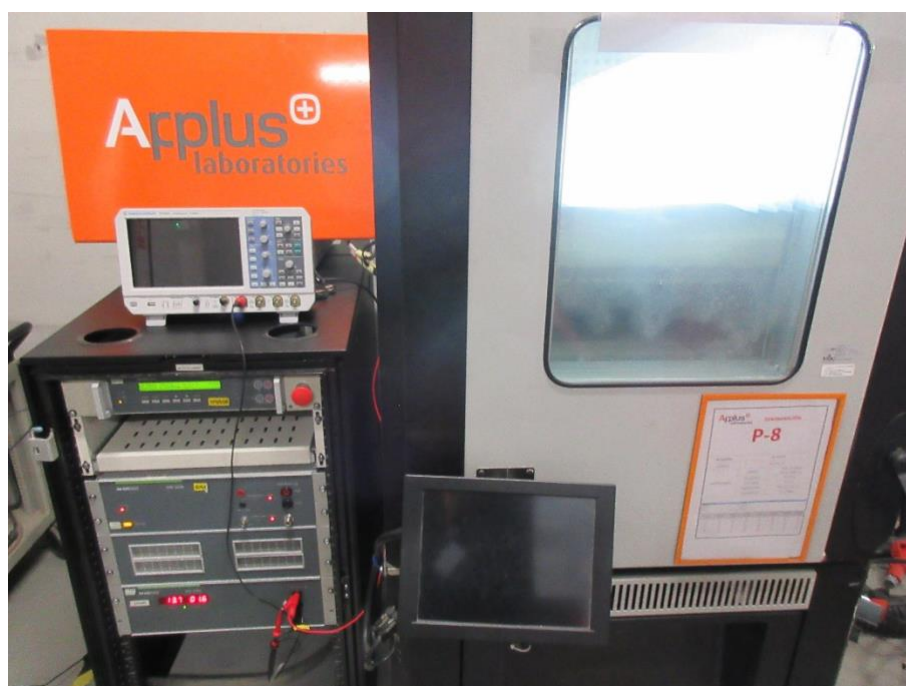
Figura 4.27 Disposición del EUT en el plano de masa según la normativa Ford FMC1278.
