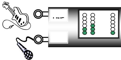
La pantalla de representación consiste en un conjunto de N columnas a modo de vúmetros (o indicadores de niveles de señal, como el volumen en determinados aparatos de audio), cada una de las cuales tiene un margen dinámico de -15 a 15 V y consta de 6 leds, que se iluminan gradualmente en función del valor absoluto de la tensión de entrada  $x_v(t)$  al circuito del led, es decir:
