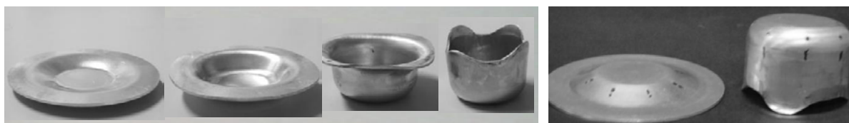
(a) S=3.7\text{mm} (b) S=8.2\text{mm} (c) S=16.3\text{mm} (d) End (e) Dimples at S=10\text{mm} (f) Dimples at the end
