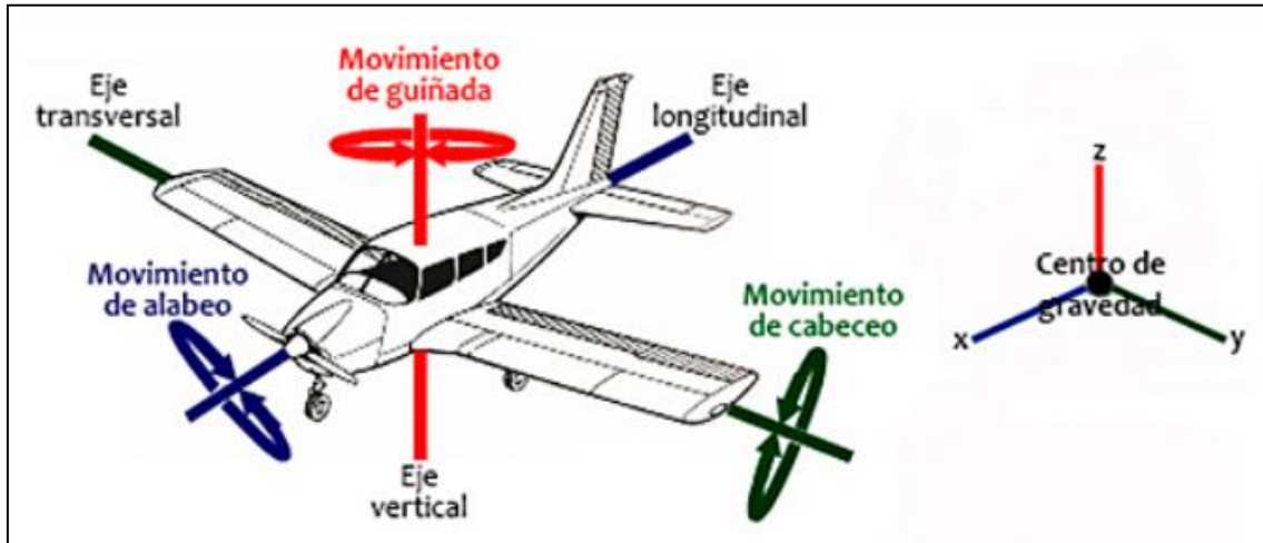
Figura 1. Ejes y movimientos de una aeronave.
