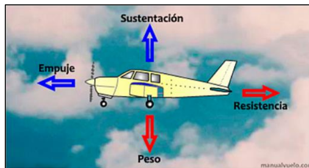
Figura 3. Fuerzas principales que actúan sobre un avión.
