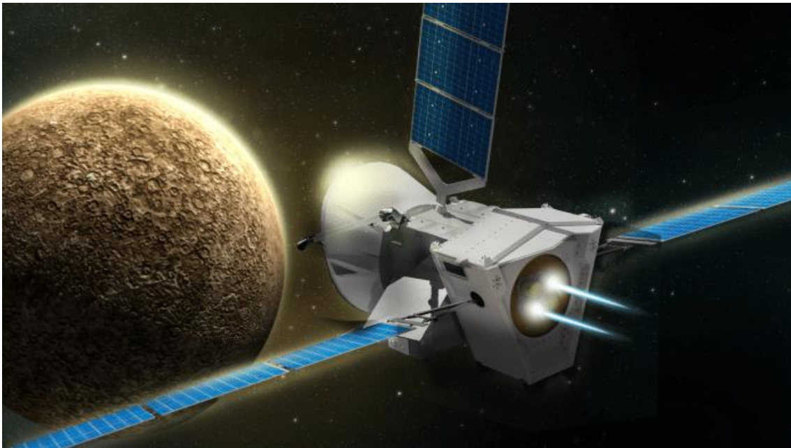
Figura 3.4 BepiColombo, el satèl·lit construït per a la ESA y la JAXA. Ilençat el octubre del 2018. Té previst arribar a mercuri el 2025 utilitzant 4 propulsors iònics. Font: Aviaciondigital
