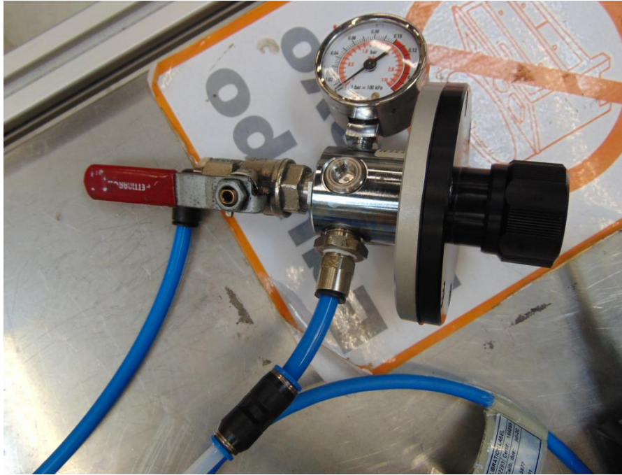
Fig.16: Manòmetre regulador de baixes pressions AirLiquide
