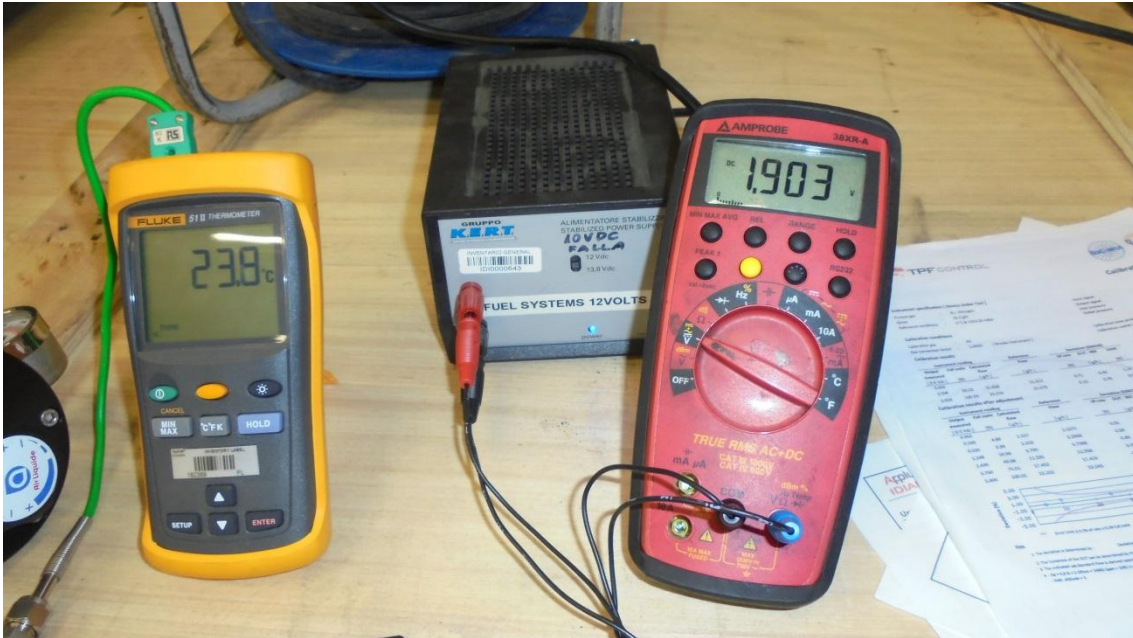
Fig. 19: Multímetre, termòmetre digital i font d'alimentació 12 V
