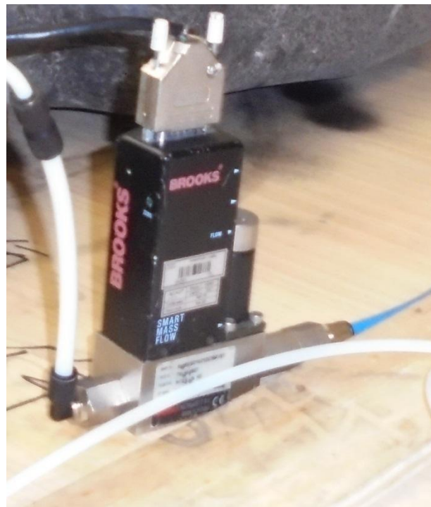
Fig. 15: Regulador de cabal (Mass Flow Meter)
