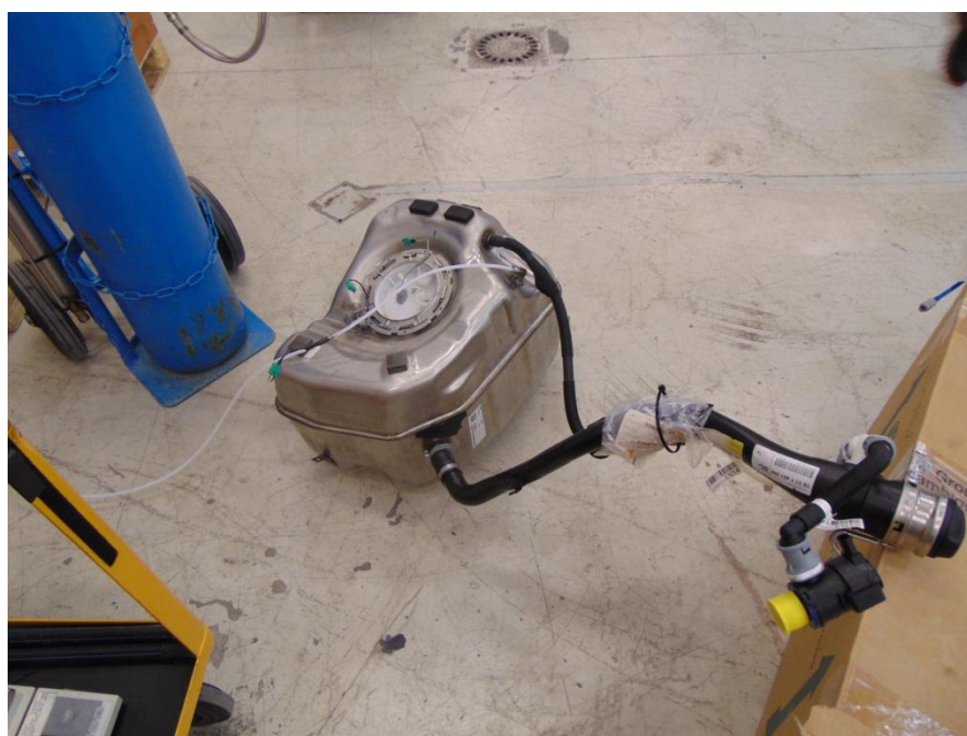
Fig. 23 : Tanc de combustible segellat PHEV → 36 litres
