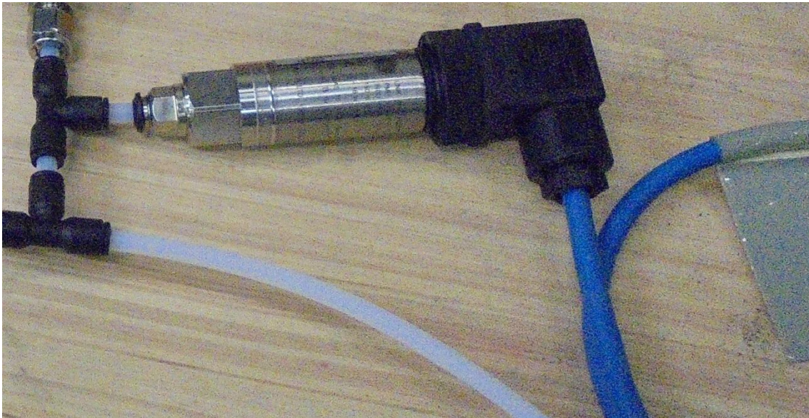
Fig. 28: Transductor de pressió de 0 mbar a 150 mbar
