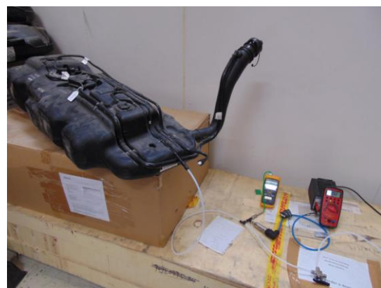
Fig.6 "Set up" assaig caiguda de pressió
