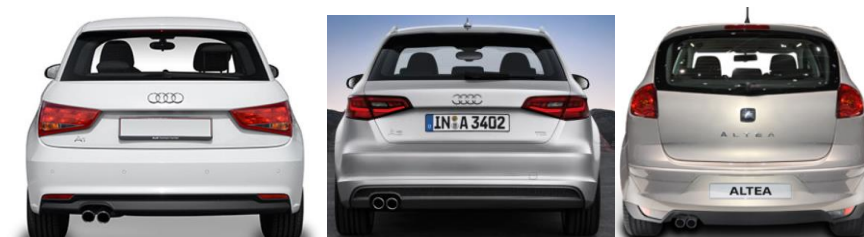
Ilustración 4. Portones Audi con piloto completo y piloto móvil, portón SEAT sin piloto
