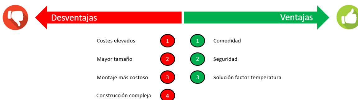
Ilustración 65. Comparativa muelle eléctrico y muelle de gas. Fuente: elaboración propia
