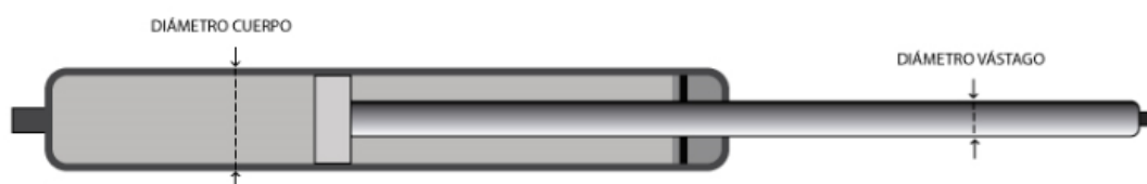
Ilustración 57. Combinación de diámetros cuerpo y vástago. Fuente: www.cromparts.com
