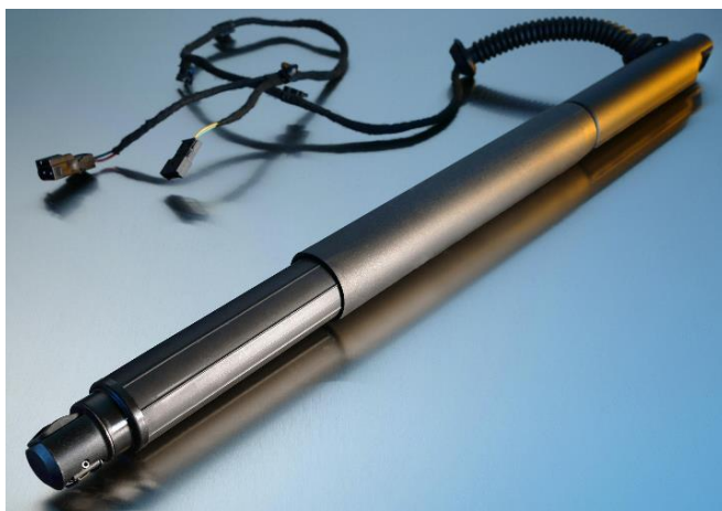
Ilustración 64. Muelle eléctrico. Fuente: www.skodacommunity.de
