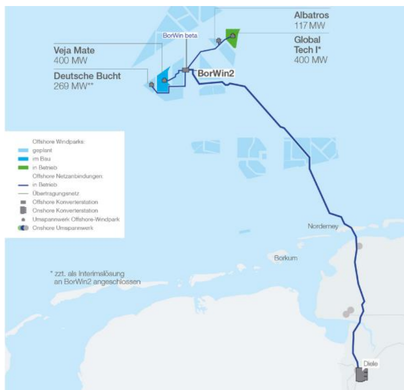
Figura 4.27: Conexión de los parques eólicos Global Tech I y Veja Mate a la subestación BorWin Beta [37].
