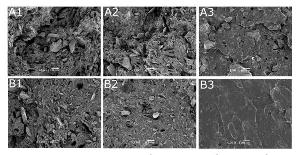
**Figure 6.** SEM images of samples: **(A1)** NR/BSG100<sup>S</sup>, **(A2)** NR/BSG/GTR50/50<sup>S</sup>, **(A3)** NR/GTR100<sup>S</sup>, **(B1)** NR/BSG100<sup>P</sup>, **(B2)** NR/BSG/GTR50/50<sup>P</sup>, **(B3)** NR/GTR100<sup>P</sup> (magnification ×100).
