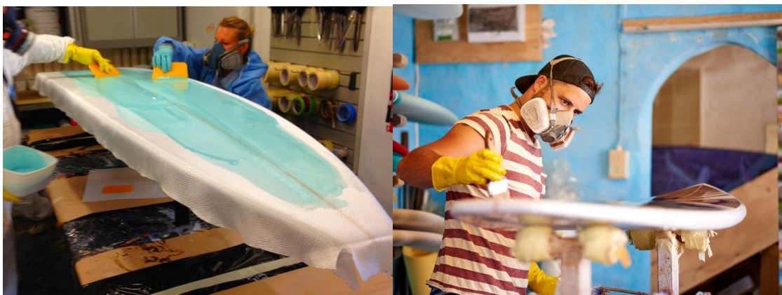
Ilustración 15. Proceso de laminado mediante resina
