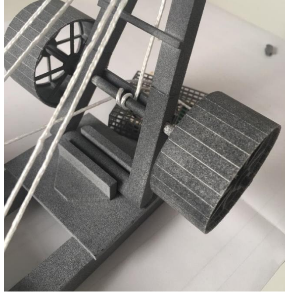
ILUSTRACIÓN 34. DETALLE BOBINADO CUERDA
