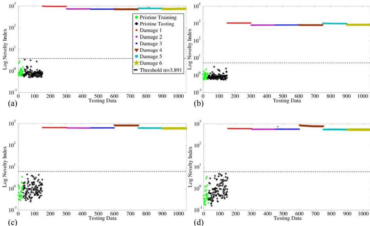
Figure 3. Outlier Analysis by means of PCA : (a) Actuator 1, (b) Actuator 2, (c) Actuator 3, (d) Actuator 4.
