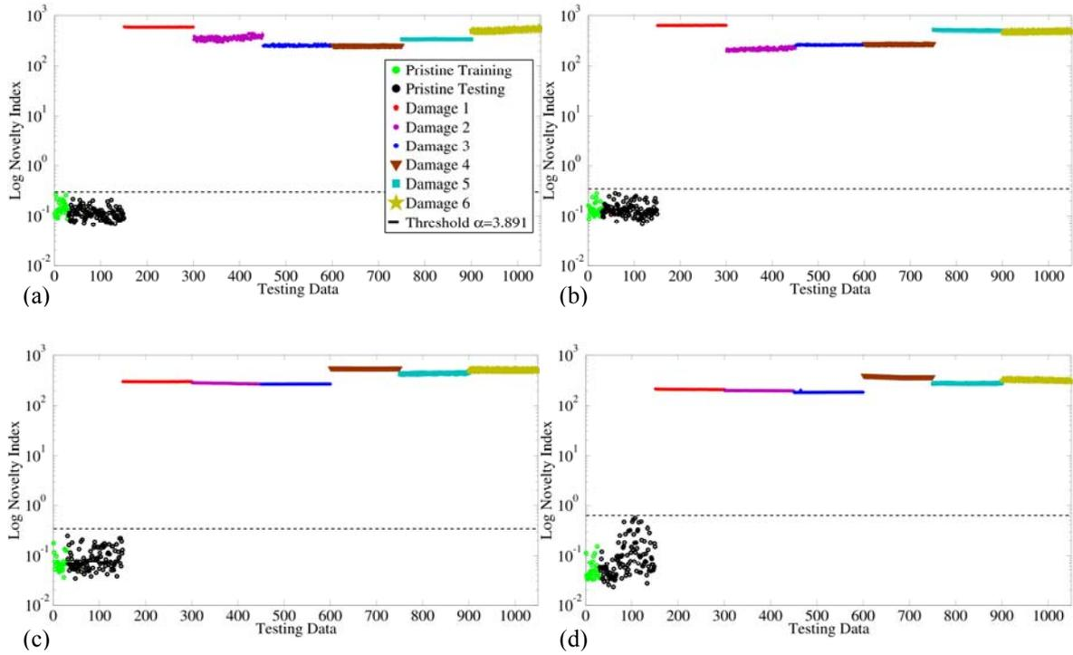
Figure 4. Outlier Analysis with h-NLPCA: (a) Actuator 1, (b) Actuator 2, (c) Actuator 3, (d) Actuator 4.
