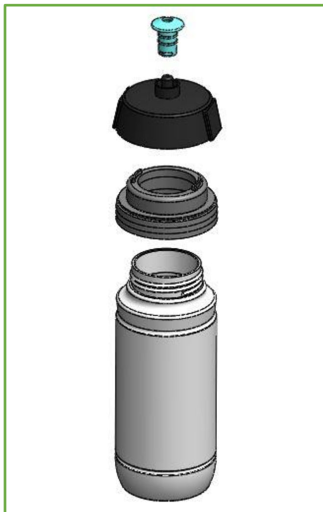
Imagen 2 - Explosionado bidón modelo 3D simplificado
