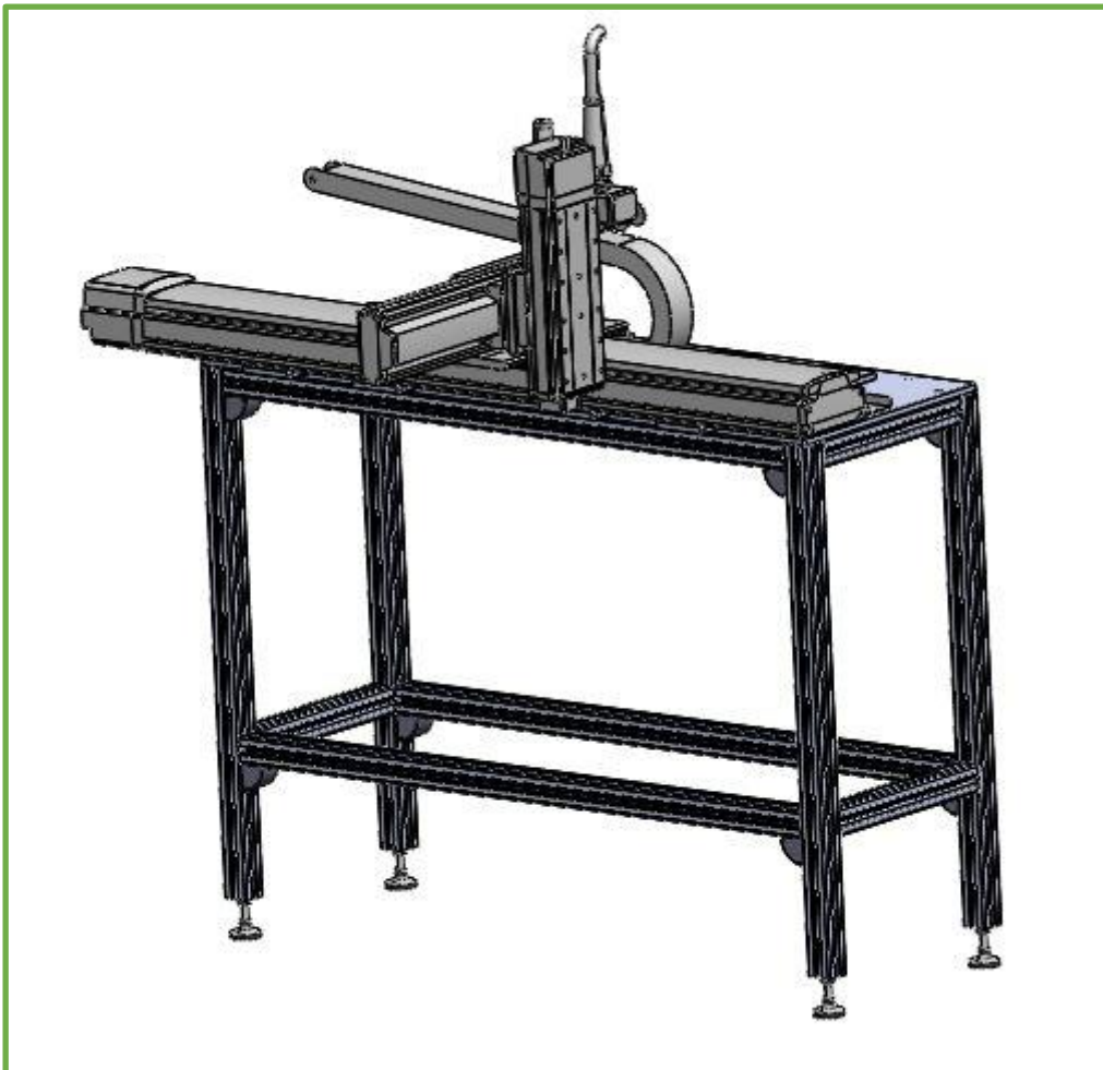
Imagen 39 - Ensamblaje robot cartesiano XYZ modelo 3D
